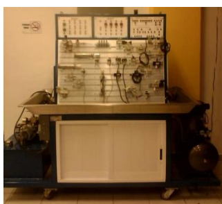
Banco de prácticas hidráulica y neumática
